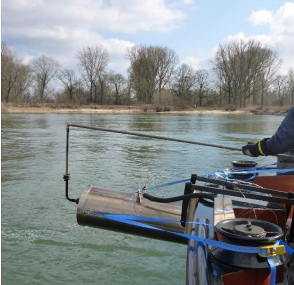
Emissionsmessung am Heck eines Binnenschiffs
